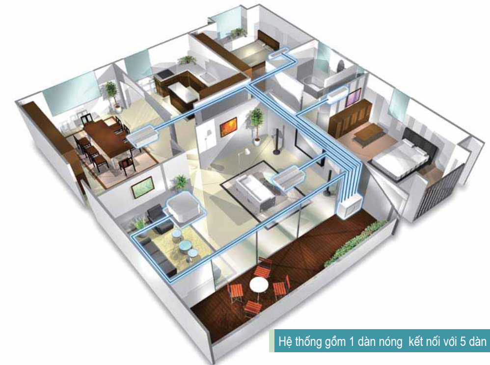
Hệ thống gồm 1 dàn nóng kết nối với 5 dàn lạnh
